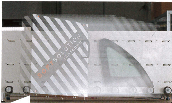
Das Bild zeigt die Bewegung der Scanner-Einheit bei der Prüfung einer Modellscheibe.
